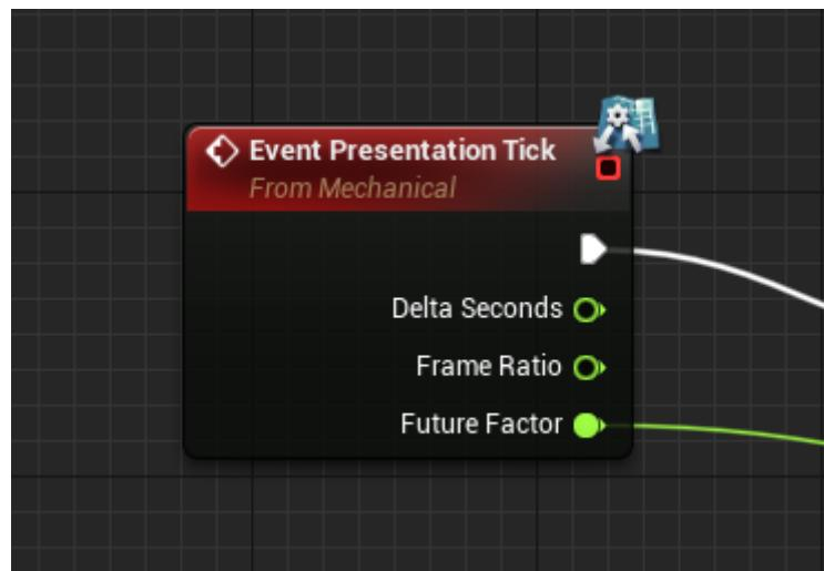
Это событие наступает после нормальных переменных тиков (а значит, и после тиков устойчивых) и подразумевает использование для вычисления визуального отклика механик. Интерполяция механик, очевидно, тоже может быть вычислена. Посмотрите на этот всеобъемлющий пример механики интерполяции 3d-положения объекта (выдержка из нашего примера-платформера):
