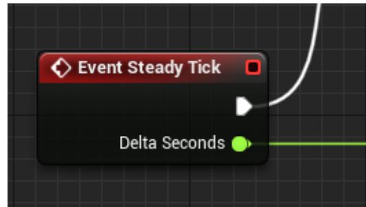
Устойчивые тики имеют фиксированный временной интервал и выполняются параллельно основным тикам (event-tick), у которых этот интервал может меняться. Слово “параллельно” совершенно не означает мульти-поточность, напротив, подчёркивает логику вызовов.
